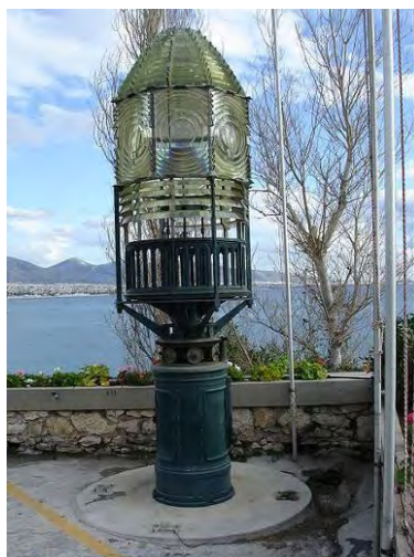
Εικόνα 57. Φαρικό οπτικό (μηχανή) τύπου Φρενέλ όπου διακρίνονται οι επάλληλοι οριζόντιοι (πάνω και κάτω) και κάθετοι ομόκεντροι δακτύλιοι (διοπτρικά στοιχεία) περιμετρικά. ( http://el.wikipedia.org/wiki/ )
