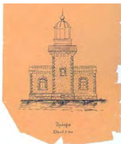
Εικόνα 35. Όψη φάρου λιθοκτιστού τύπου «τετράγωνου πύργου εις το μέσον της κατοικίας των φυλάκων». («Ελληνικοί πέτρινοι φάροι, Παπαγεωργίου Γήσης, εκδόσεις Άμμος, 2006)
