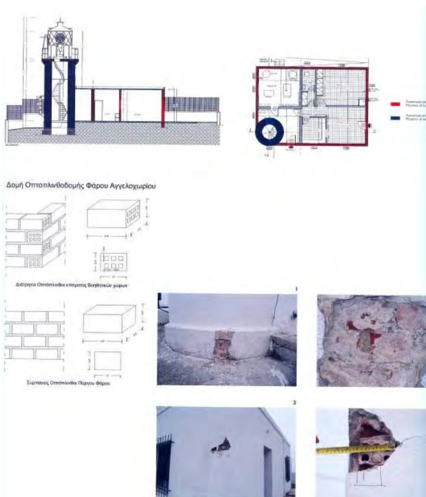
Εικόνα 71. Συμπλεγείς (με μπλε χρώμα)πλίνθοι τοιχοποιίας πύργου φάρου και διάτρητοι πλίνθοι τοιχοποιίας (με κόκκινο χρώμα) βοηθητικού κτίσματος Φάρου Μεγάλου Εμβόλου, Αγγελοχώρι, Ελλάδα
